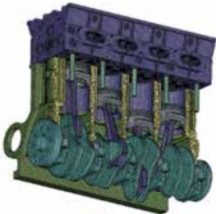
24시간 내에 CAD로부터 내구 엔진 해석 자동화를 통해 Bore의 왜곡을 분석
