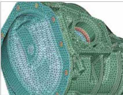
24시간 내에 트랜스미션 NVH 해석 자동화를 통해 진동 결과를 분석
